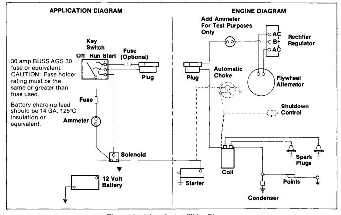
Figure 6-9. 15 Amp System Wiring Diagram
