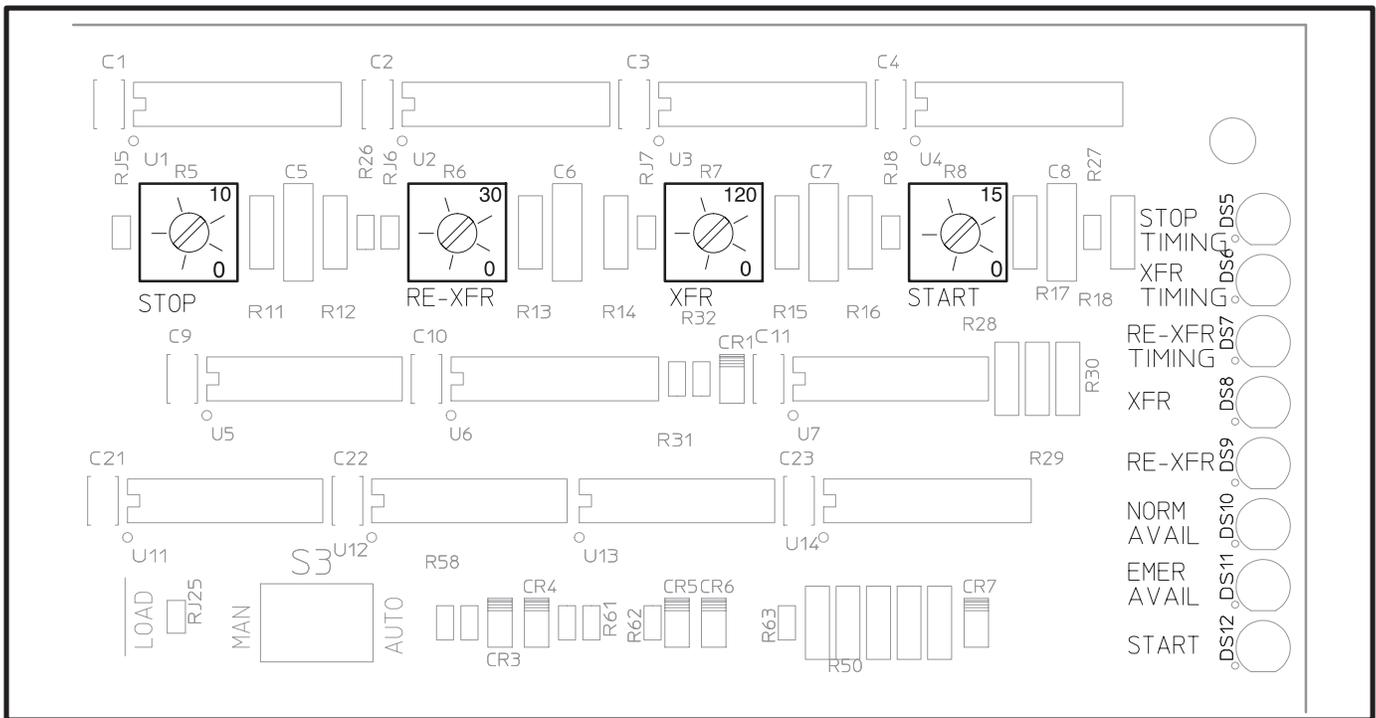
FIGURE 4-4. CONTROL PACKAGE B TIME DELAY ADJUSTMENT
