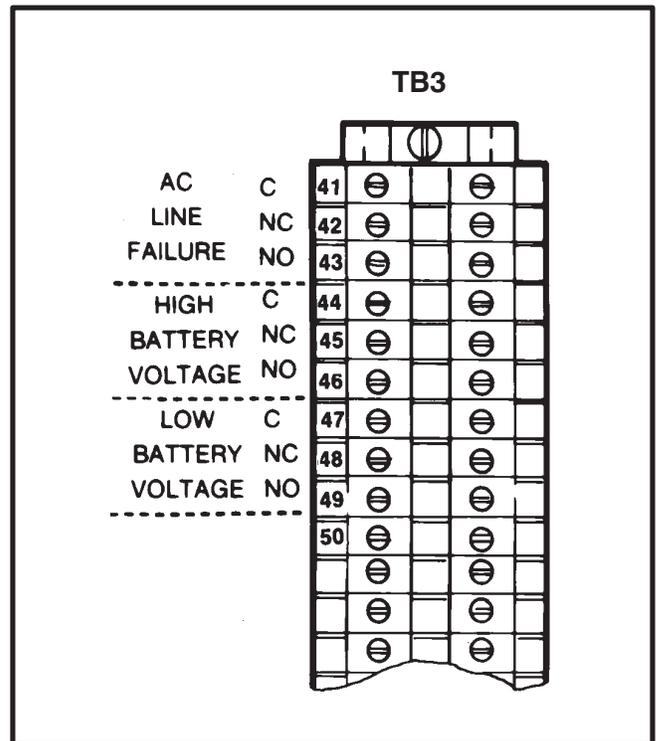
FIGURE 3-7. BATTERY CHARGER ALARM CONTACTS (SHOWN DE-ENERGIZED)
