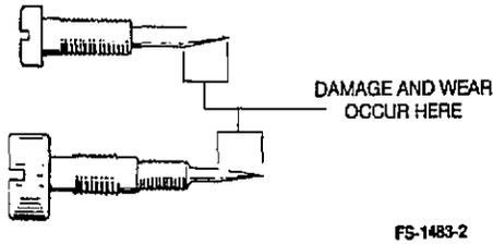
FIGURE 6-11. MIXTURE NEEDLE INSPECTION
