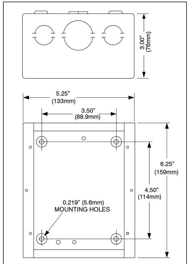
**FIGURE 5. ANNUNCIATOR CONTROL BOX FOOTPRINT**
