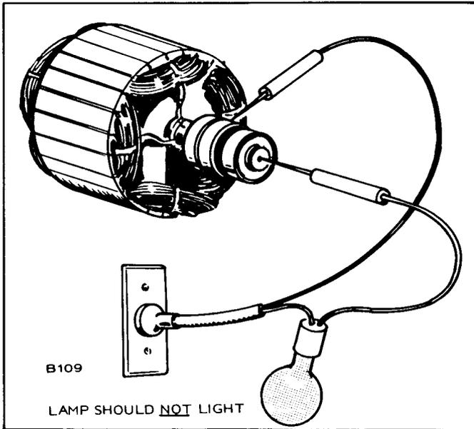
FIGURE 51. ARMATURE GROUND TEST
