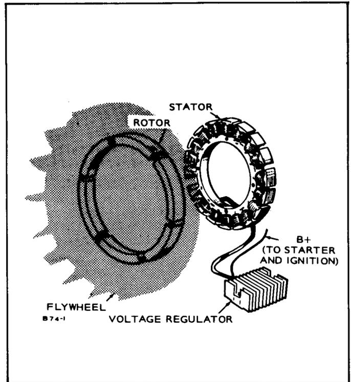
FIGURE 41. FLYWHEEL ALTERNATOR SYSTEM
