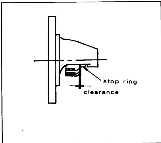
FIGURE 47. PINION CLEARANCE
