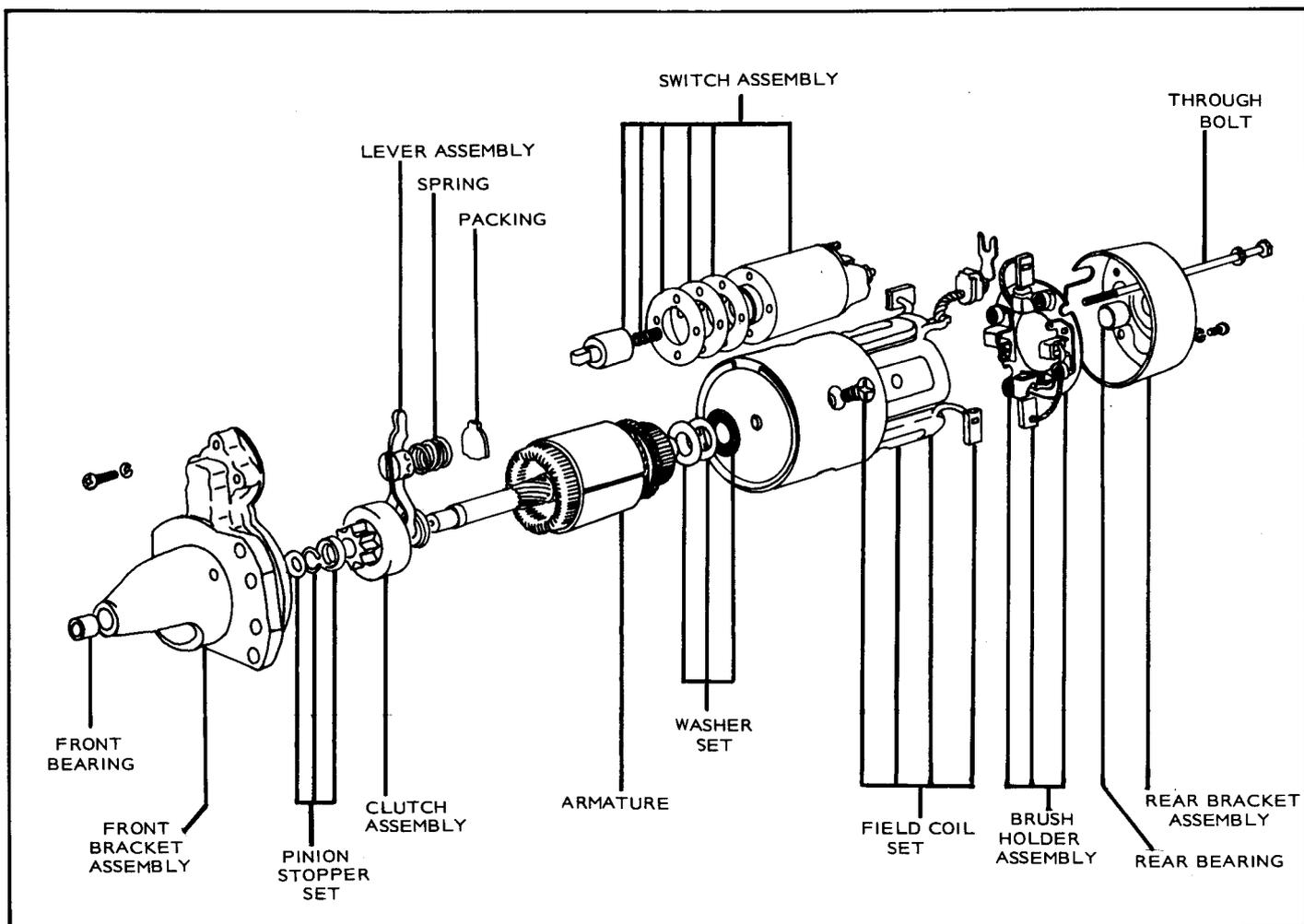
FIGURE 44. STARTER EXPLODED VIEW
