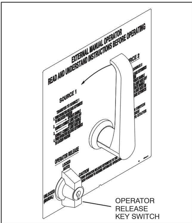
FIGURE 2-7. EXTERNAL MANUAL OPERATION HANDLE
