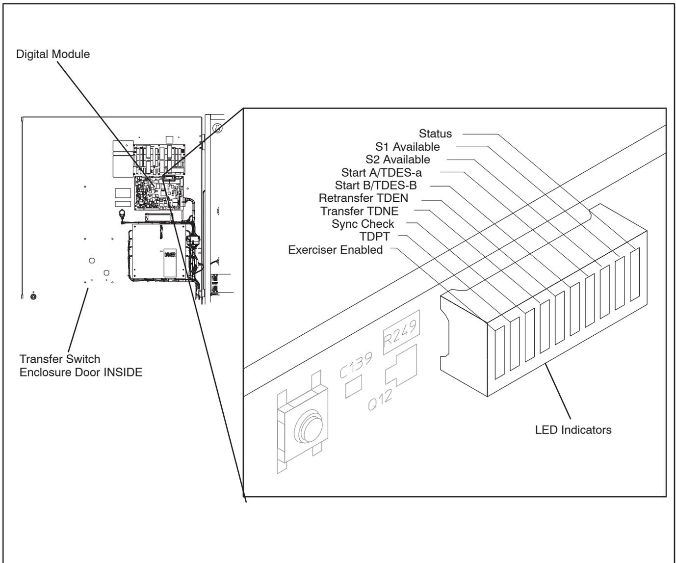
FIGURE 32-1. LED LOCATION ON DIGITAL MODULE (SHOWN ON LEVEL 1 SWITCH)
