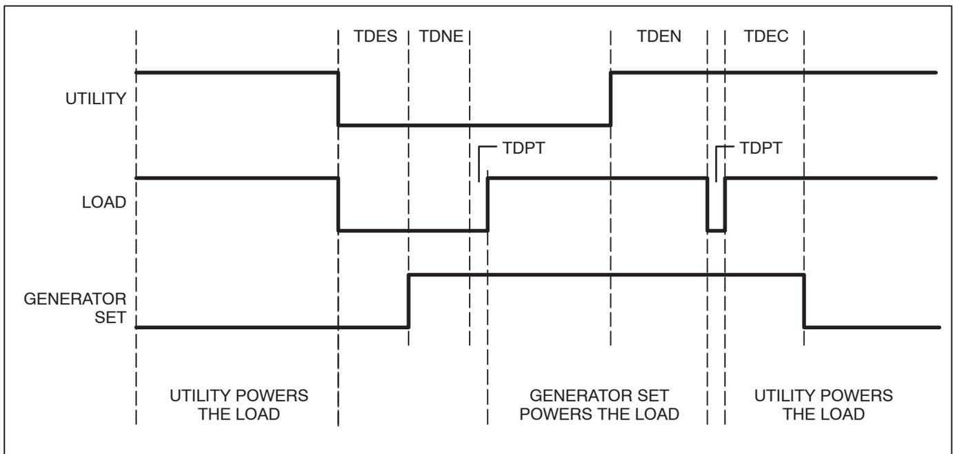
FIGURE 1-2. OHPC SEQUENCE OF OPERATION
