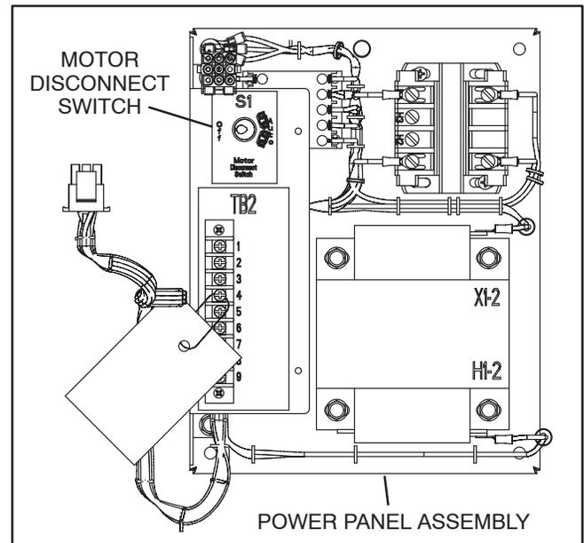
**FIGURE 2-15. MOTOR DISCONNECT SWITCH**
