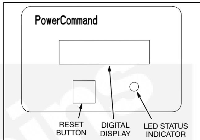
**FIGURE 2-47. 15/12-AMP CHARGER CONTROL PANEL**
