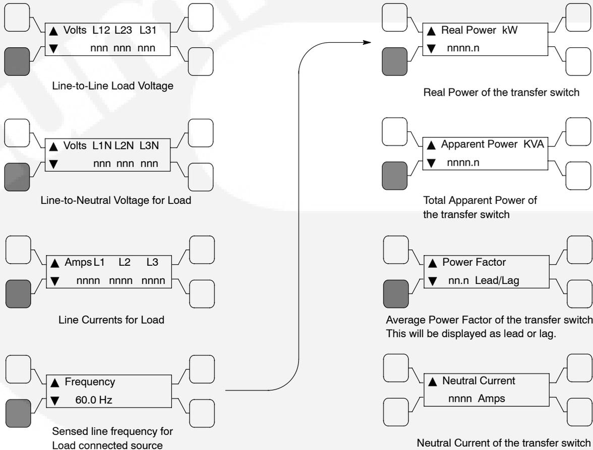
FIGURE 4-4. LOAD SUBMENUS
