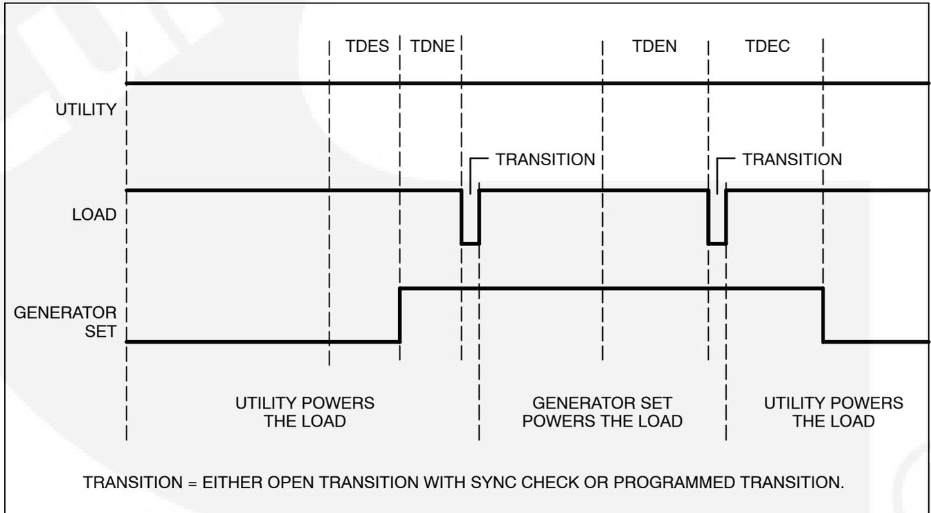
FIGURE 2-28. FRONT PANEL TEST SEQUENCE OF OPERATION
