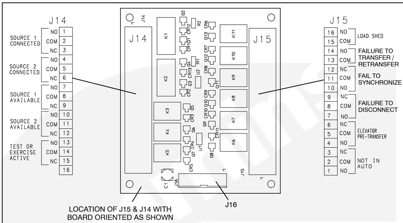
**FIGURE 2-52. RELAY MODULE**
