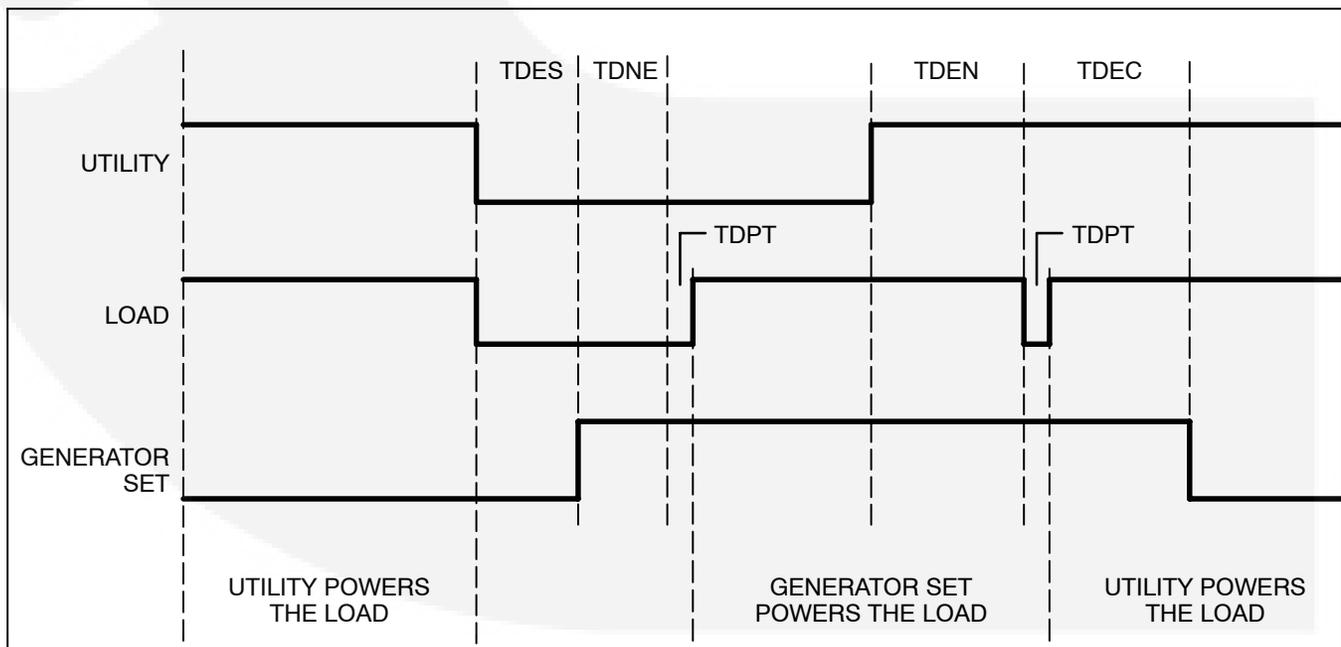
FIGURE 2-27. PROGRAMMED TRANSITION SEQUENCE OF OPERATION
