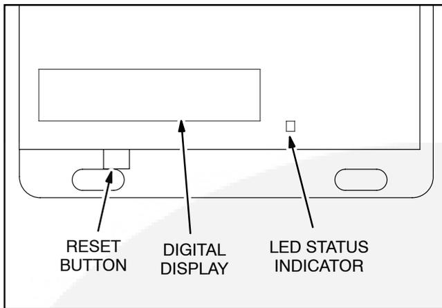
**FIGURE 2-46. 2-AMP CHARGER CONTROL PANEL**
