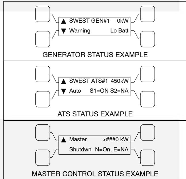
FIGURE 2-61. SYSTEM SUBMENUS
