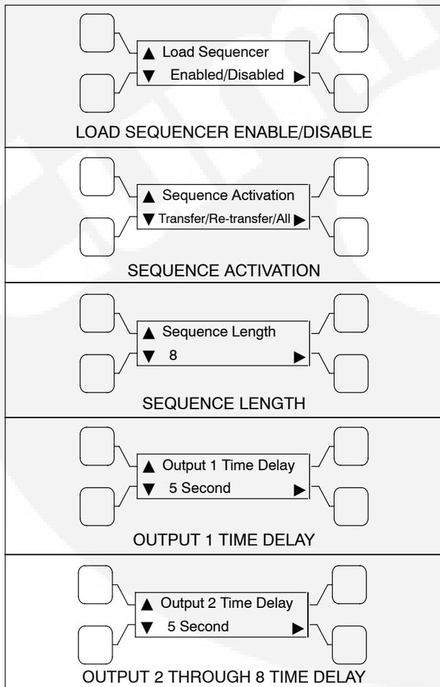
FIGURE 2-60. SEQUENCER SUBMENUS
