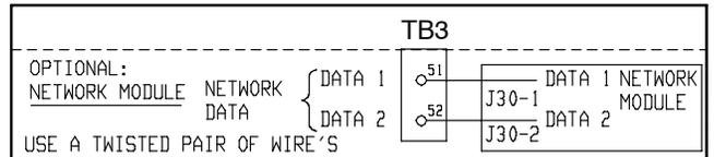
**FIGURE 2-58. NETWORK COMMUNICATIONS MODULE CONNECTIONS**
