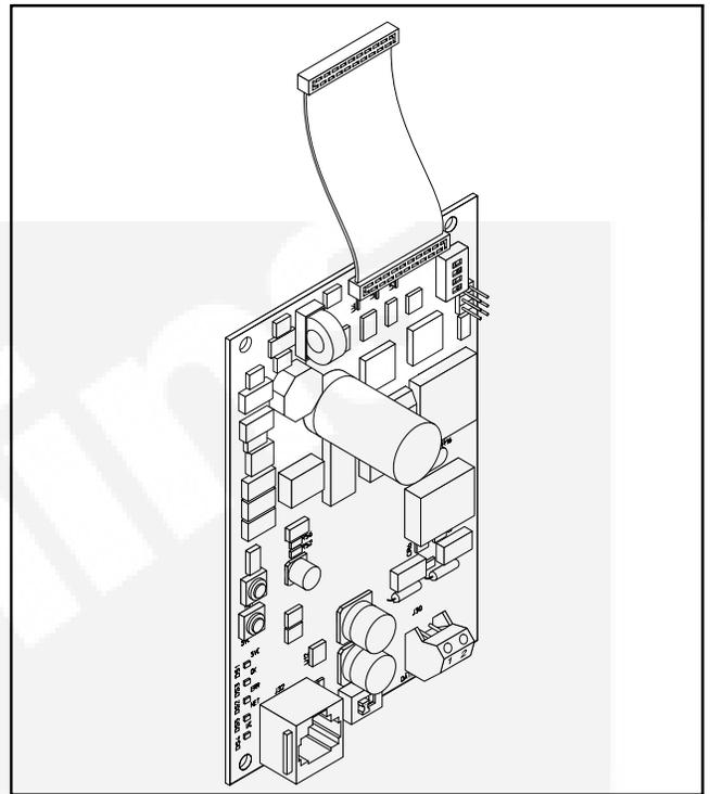
**FIGURE 2-56. FIGURE 2-57. NETWORK COMMUNICATIONS MODULE (NCM)**
