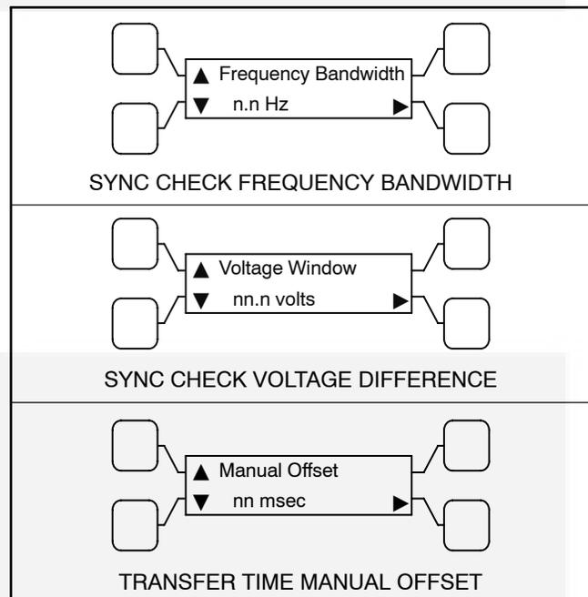
**FIGURE 2-25. SYNCHRONICITY PARAMETER SUBMENUS**
