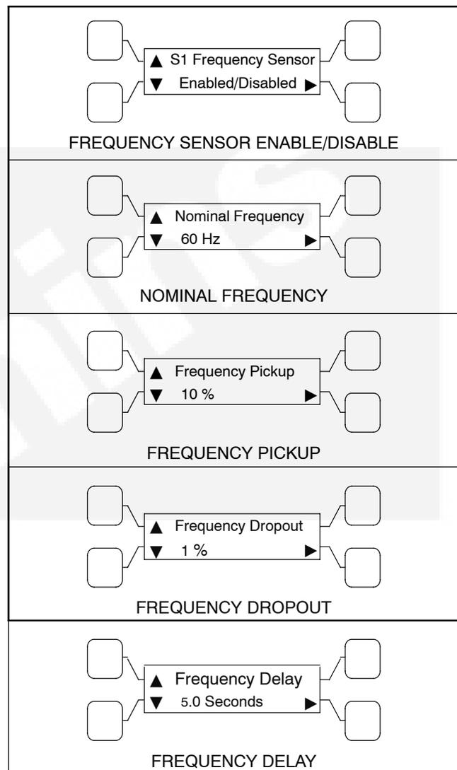
FIGURE 2-18. FREQUENCY SUBMENUS
