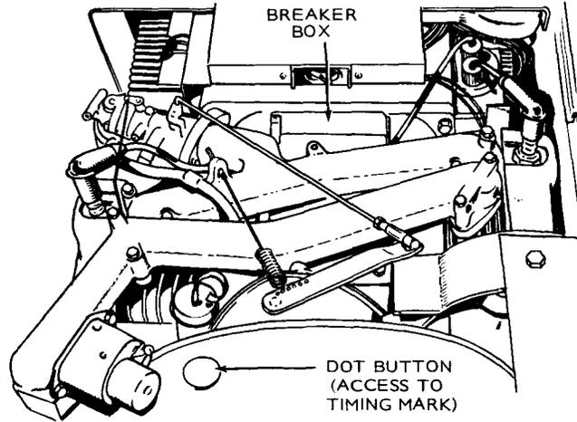
FIGURE 14. BREAKER BOX AND TIMING MARK LOCATION
