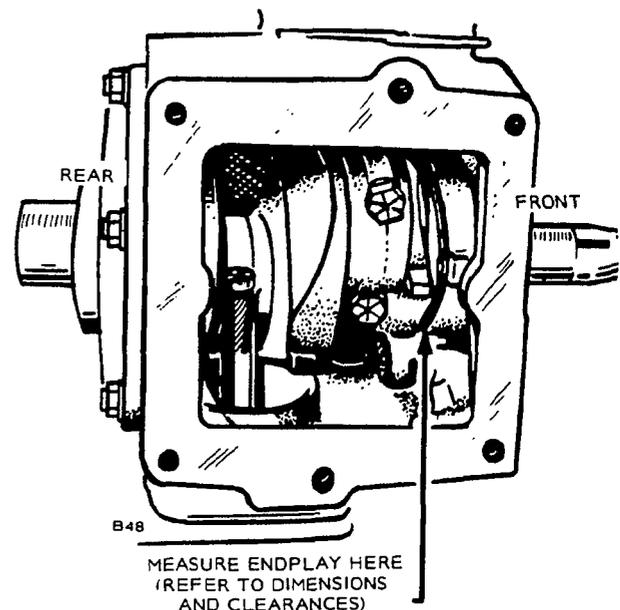
**FIGURE 23. CRANKSHAFT ENDPLAY**
