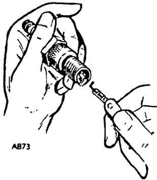
FIGURE 6. SPARK PLUG GAP
