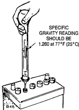
FIGURE 7. SPECIFIC GRAVITY TEST
