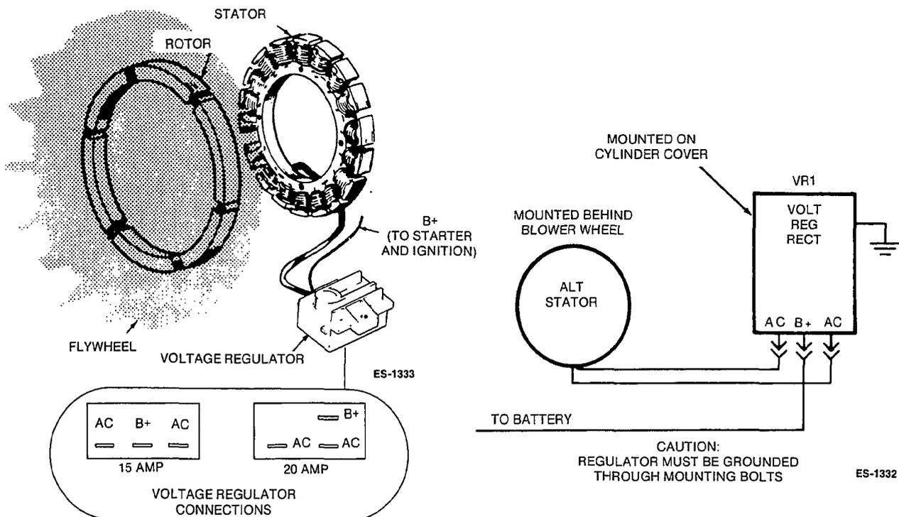
FIGURE 9. FLYWHEEL ALTERNATOR SYSTEM
