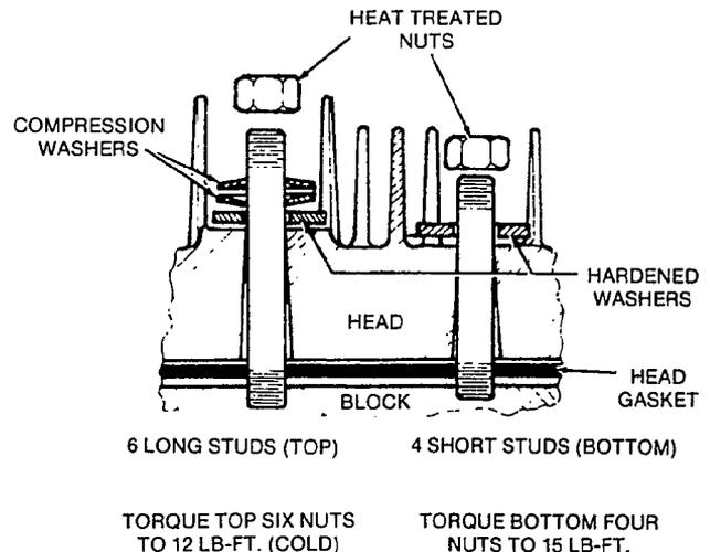
FIGURE 31. CYLINDER HEAD STUDS
