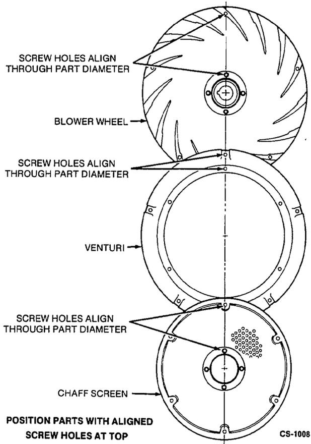
**FIGURE 34. BLOWER WHEEL, VENTURI AND CHAFF SCREEN ALIGNMENT**
