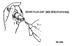
FIGURE 6-4. MEASURING PLUG GAP
