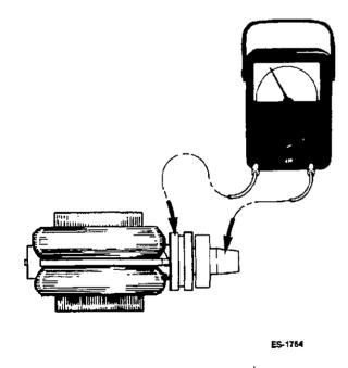
FIGURE 8-10. GROUNDED ROTOR TEST
