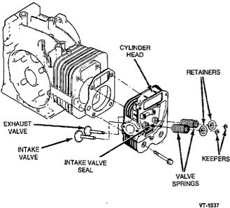
FIGURE 9-4. OVERHEAD VALVE SYSTEM
