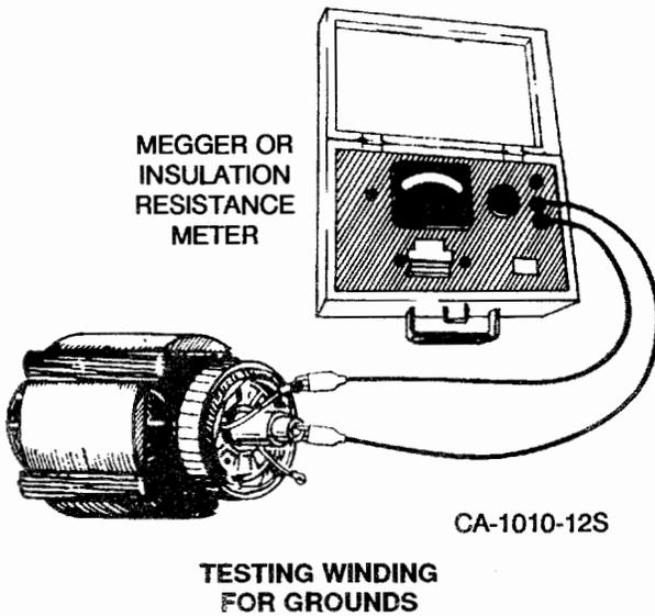
FIGURE 6-7. TESTING ROTOR FOR GROUNDS
