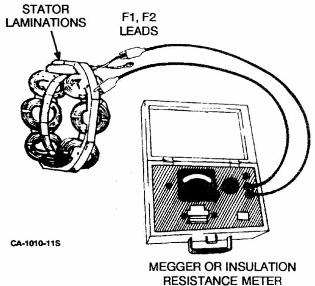
FIGURE 6-4. TESTING EXCITER STATOR
