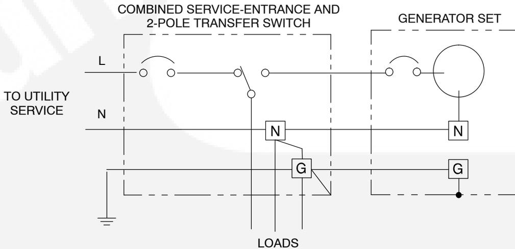
**FIGURE 4-2. TYPICAL SYSTEM GROUNDING ONE-LINE DIAGRAMS**
