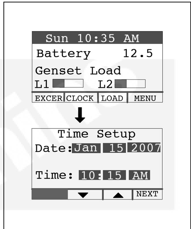
FIGURE A-14. TIME SETUP SCREEN
