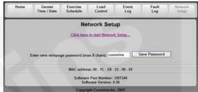
FIGURE B-8. NETWORK SETUP SCREEN
