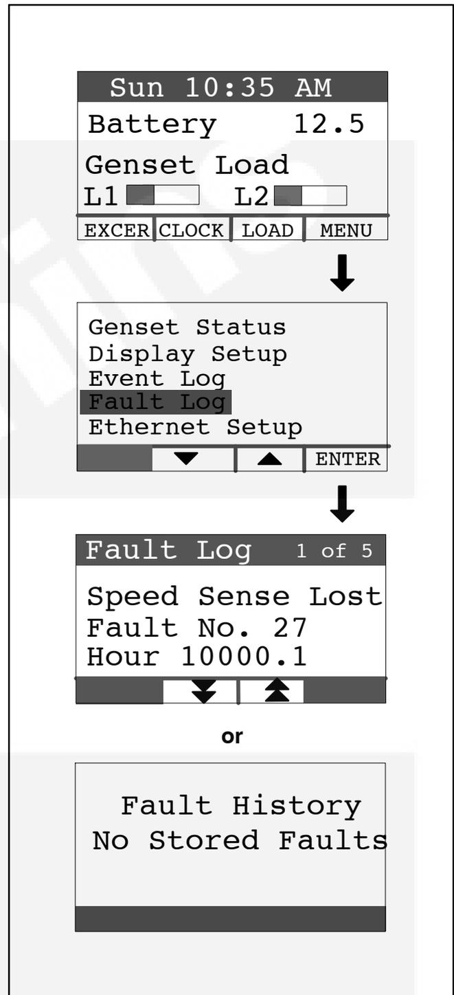
FIGURE A-11. FAULT LOG SCREEN
