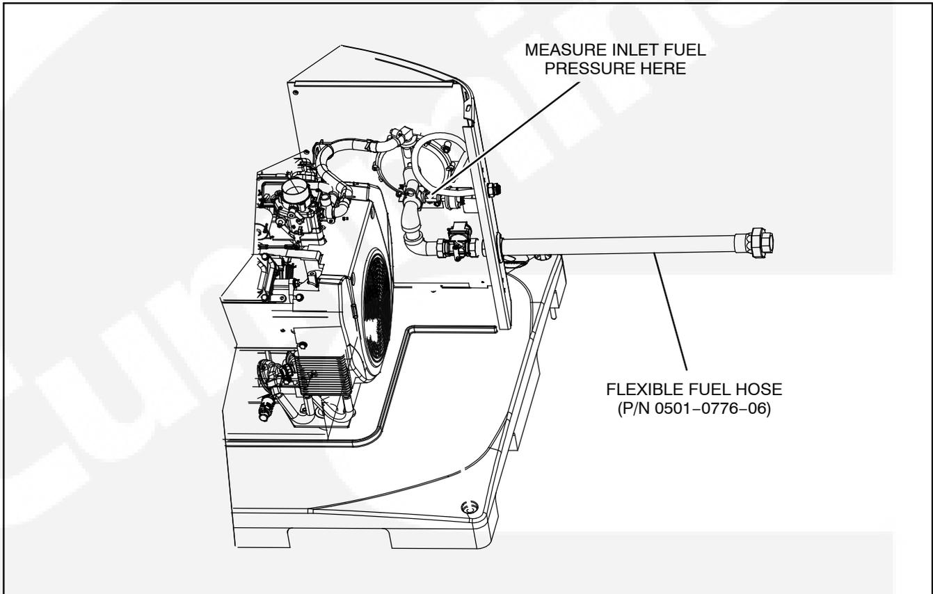
FIGURE 2-4. GAS LINE CONNECTIONS
