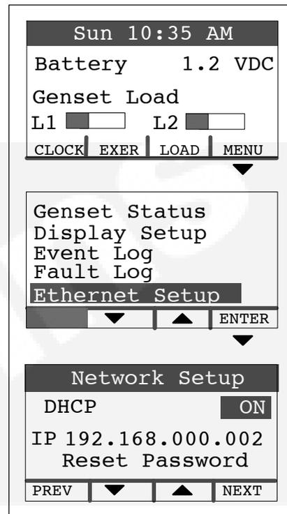
FIGURE C-2. NETWORK SETUP SCREEN ON THE IN-HOME OPERATOR PANEL
