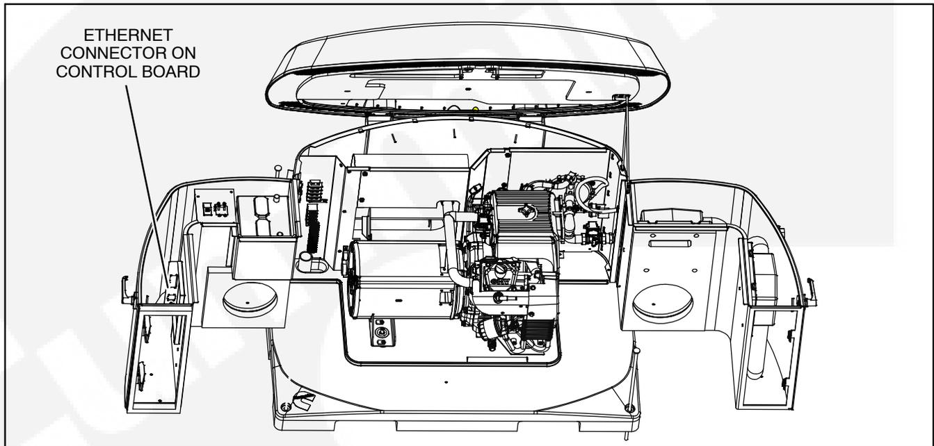
FIGURE 4-8. ETHERNET CONNECTOR
