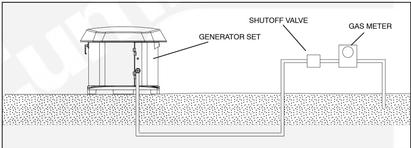
FIGURE 3-1. TYPICAL NATURAL GAS INSTALLATION
