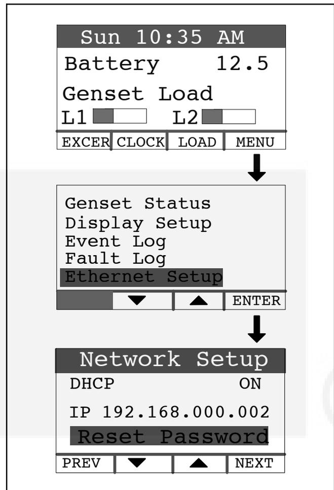
FIGURE A-12. NETWORK SETUP SCREEN
