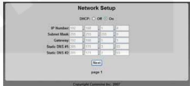
FIGURE B-9. NETWORK SETUP PARAMETERS
